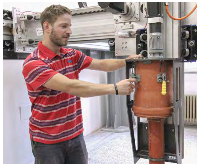
David Čítek vom Klokner-Institut demonstriert den Druckkopf von Printing Mantis, der mit B&R-Antriebstechnik die eigens entwickelte Betonmischung ausgibt.
