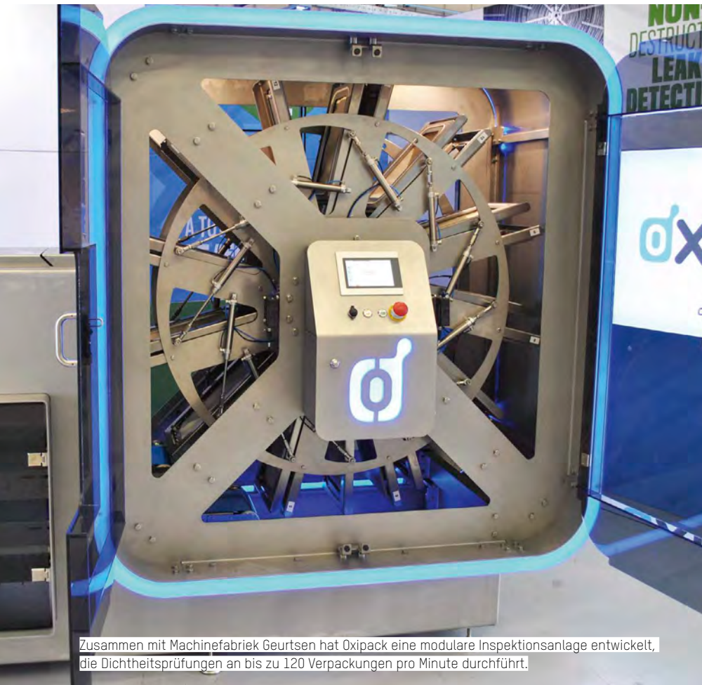
Die Inspektionsanlage von Oxipack verfügt über ein vollständig synchronisiertes Steuerungssystem. Dadurch laufen sämtliche Bewegungen äußerst synchron ab.
