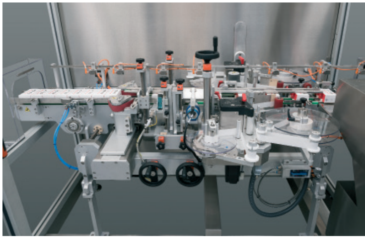
Die Antriebstechnik von B&R sorgt für synchronisierte Bewegungen für eine präzise Etikettenapplikation.
