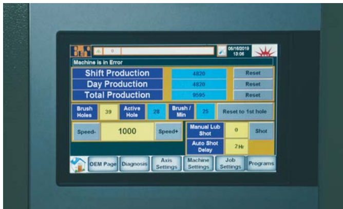
Der Panel PC kann sowohl die CNC-Anwendung als auch die I/O-Module und die Antriebstechnik steuern.
