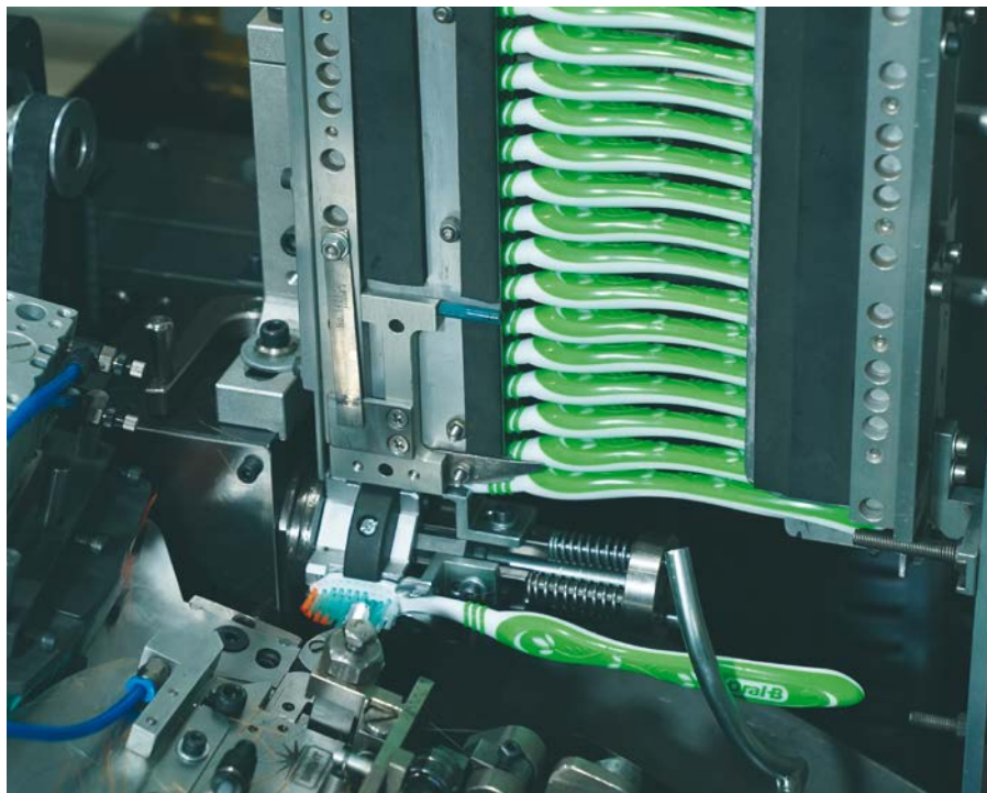
Die Tuftingmaschinen, die die Zahnbürsten beborsten, der BT1000-Serie von Bright Machine Tools sind hochsynchronisierte CNC-Maschinen.
