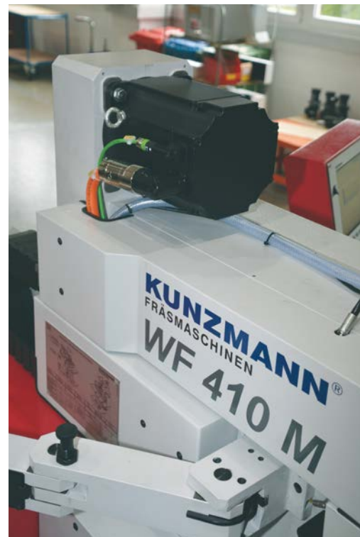
Kraftpaket: Durch den Austausch einer Asynchronmaschine gegen einen lüfterlosen B&R-Servomotor hat Kunzmann den vom Spindelmotor eingenommen Raum fast halbiert.
