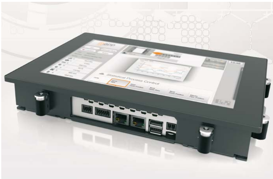
Um die Leistungsfähigkeit optimal nutzen zu können, hat das Power Panel C50 eine Vielzahl an Schnittstellen bereits integriert, zum Beispiel POWERLINK, Ethernet und USB.
