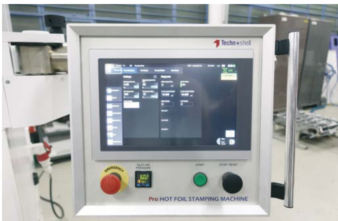
Der Panel PC 2100 läuft mit dem Windows-basierten Echtzeitbetriebssystem AR-Win von B&R und bietet die notwendige Robustheit für industrielle Anwendungen.
