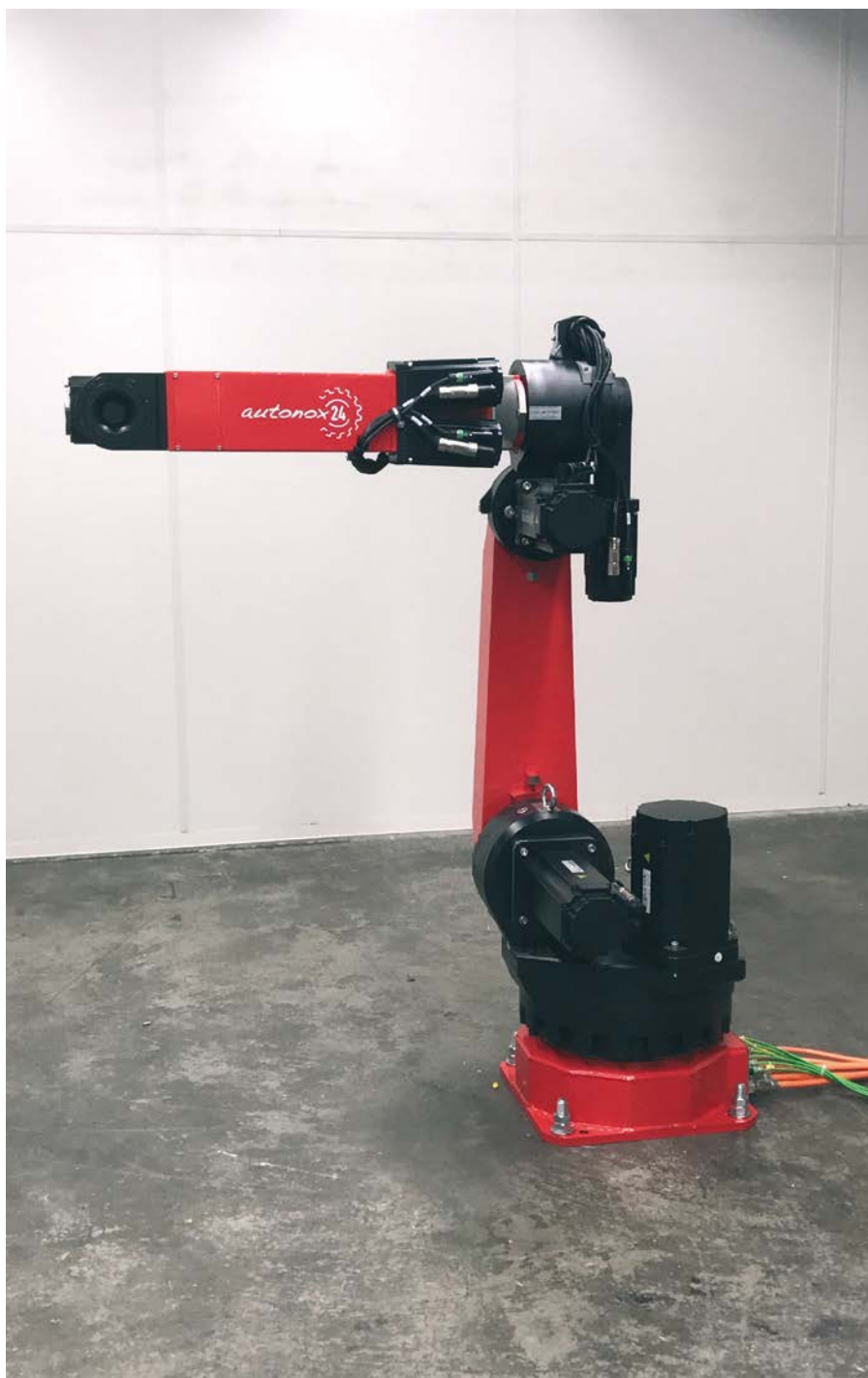
MAJAtronic bieten neben Delta- und DuoPod-Kinematiken jetzt auch steuerungsunabhängige 6-Achs-Knickarmroboter, die sich problemlos in B&R-Maschinensteuerungen integrieren lassen. Mit der Hilfe von mapp Technology benötigt der Anwender dafür kein spezielles Roboter-Know-how.
