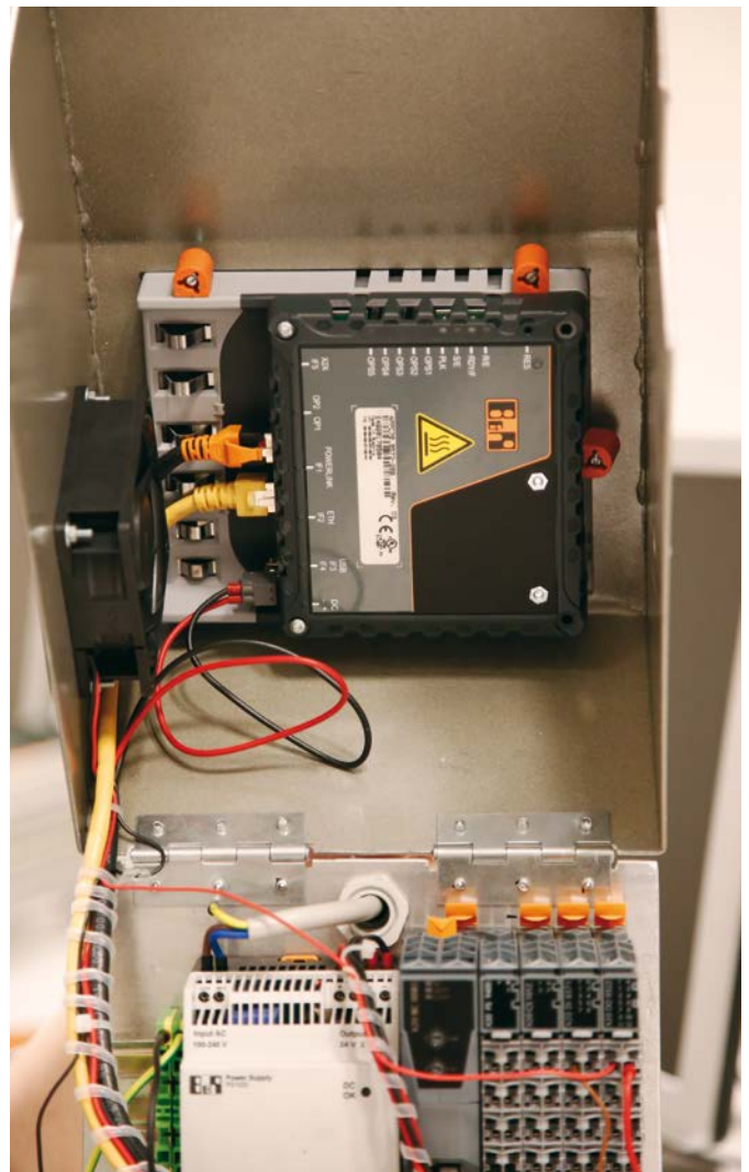
Das Innere des Alugehäuses WaterStop mit den von B&R zur Verfügung gestellten Komponenten.
