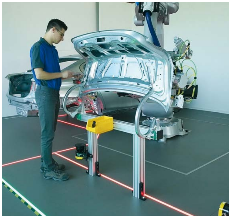
Der Roboter fixiert das Werkstück und ist im sicheren Halt, während die Scharniere manuell befestigt werden.
