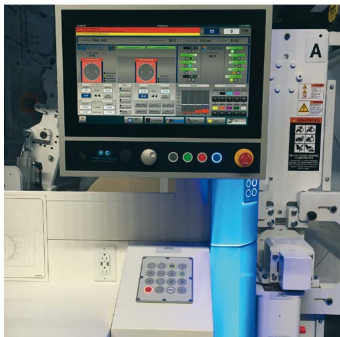
Die von PCMC und B&R gemeinsam entwickelten Lösungen, zum Beispiel vernetzte Leuchtringtasten, vereinfachen die Steuertopologie der Maschine, indem verdrahtete Komponenten, wie Drucktasten, ersetzt werden.
