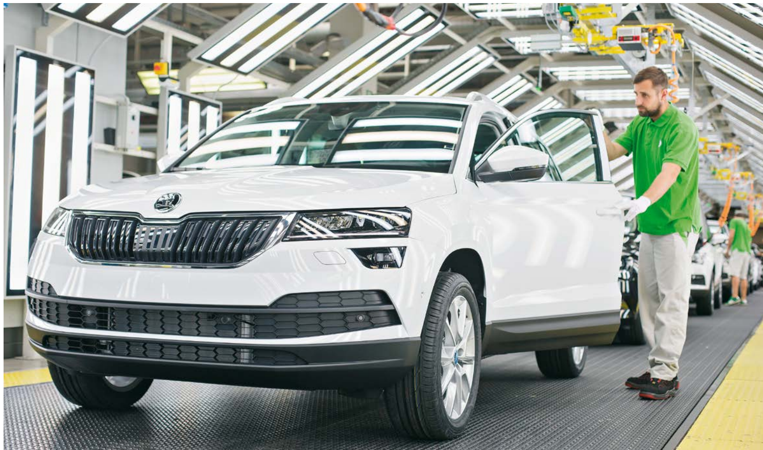
Mit einer Geschwindigkeit von 11 Meter/min verlässt alle 37 Sekunden eine Karosserie das Band – rund um die Uhr, 24 Stunden täglich.
