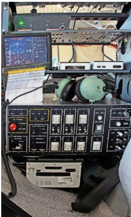
Beim Forschungsflugzeug der TU München wurde ein Sitzplatz entfernt um stattdessen experimentelle Systeme und B&R-Technik einbauen zu können.
