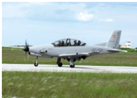
Der zivile Kunstflugtrainer DART-450 verfügt über eine maximale Startleistung von 500 PS, Sidestick und Schleudersitze.
