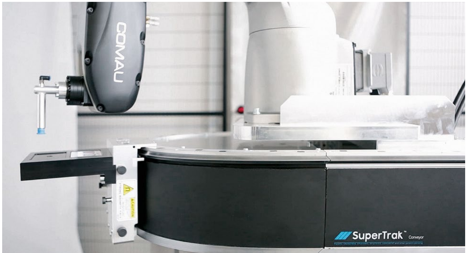
Die Shuttle-Bewegung kann als Achse eines CNC-Verbundes oder einer Roboter-Applikation genutzt werden.
