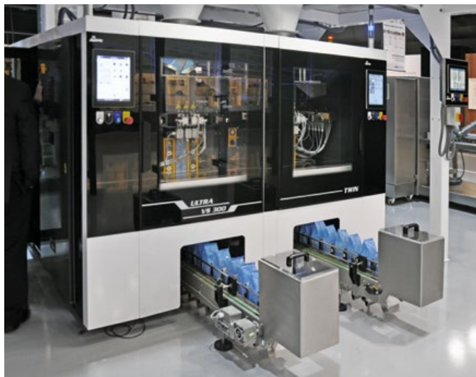
Die Konfiguration der Ultra VS 300 sorgt für eine sauberere Arbeitsumgebung und vereinfacht die Maschinenbedienung.
