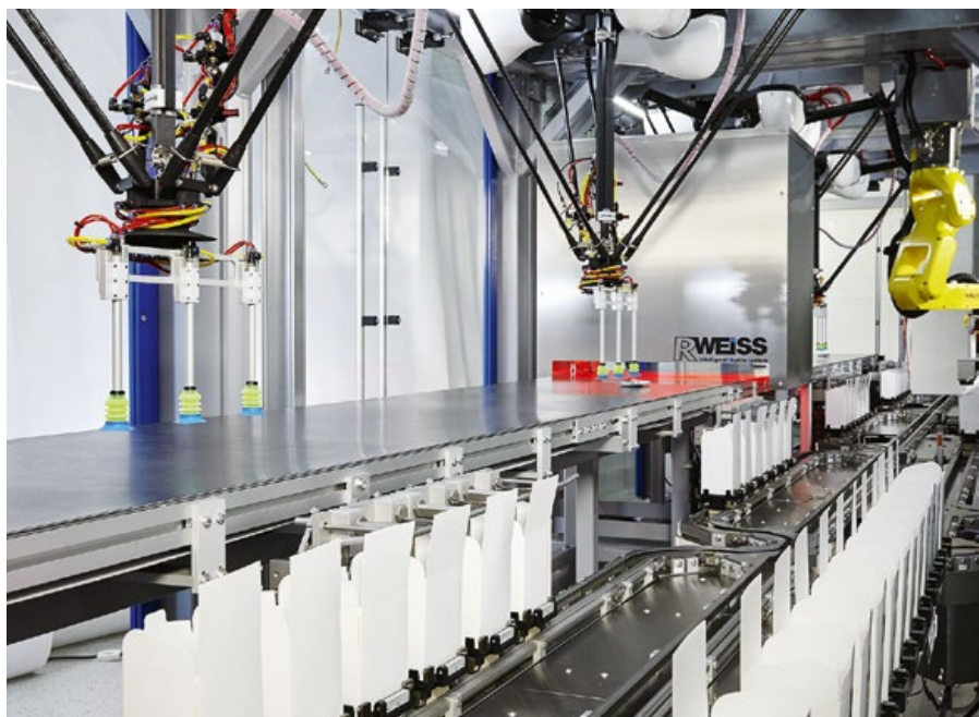
Delta-Roboter und ein intelligentes Shuttlesystem für den Transport von Produkten und Verpackungen sorgen für höchste Flexibilität der Verpackungsanlagen im Betrieb.
