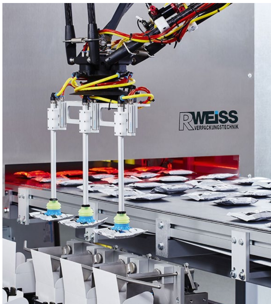
Die Steuerung der Delta-Roboter übernimmt die B&R-Steuerung. Anwender können die Roboterbewegungen bei Format- oder Produktwechseln über die Bedienerschnittstelle einfach anpassen.
