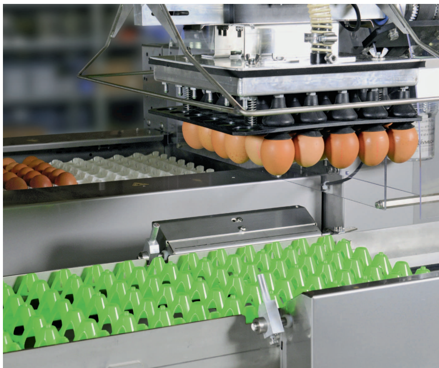
Transport der Eier mit dem Ovosep Pro von Prinzen, der ebenfalls B&R-Technik beinhaltet.
