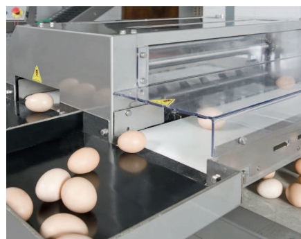
Abhängig von ihrem Gewicht werden die Eier auf die 3 Ausgänge des Ovograder verteilt.
