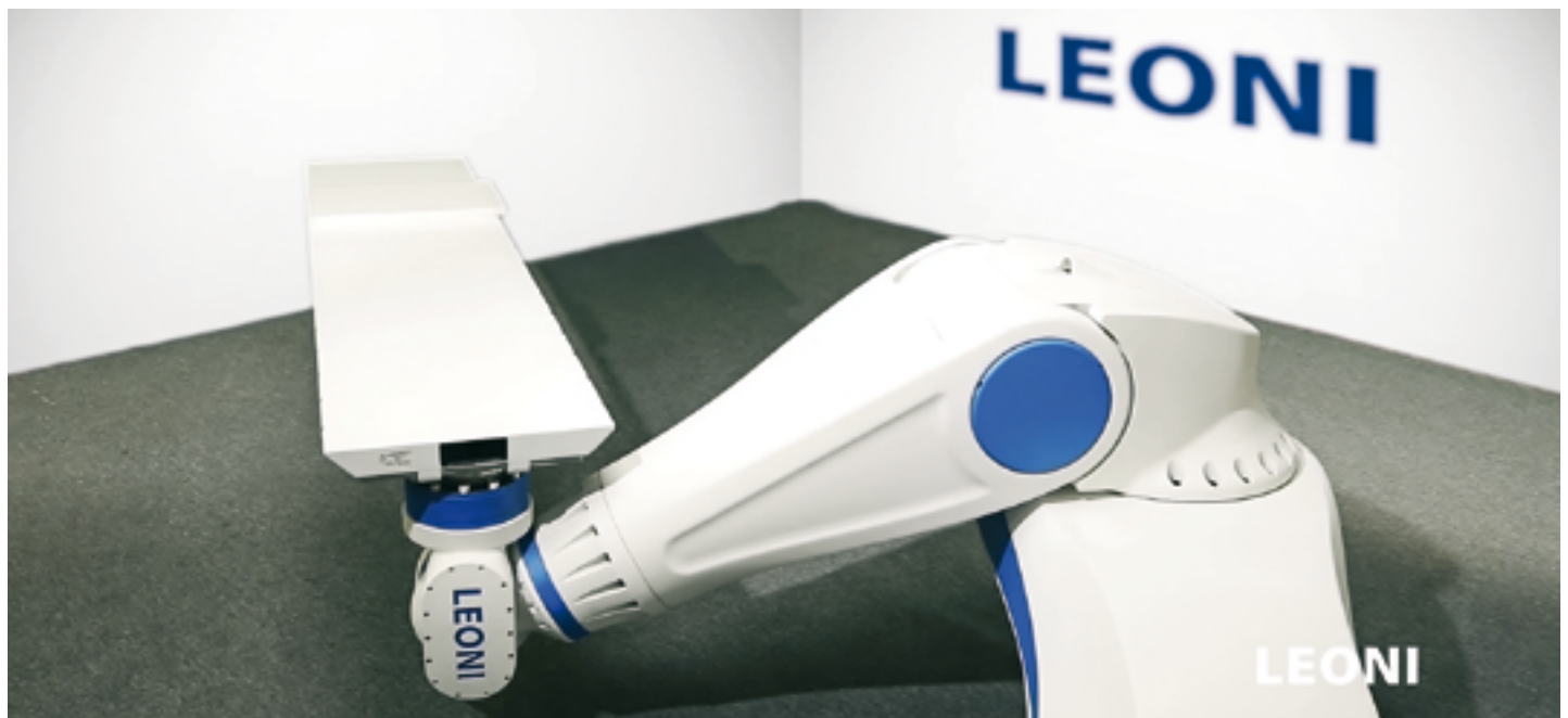
Das Leoni-Orion-System bietet eine dynamische Positioniersteuerung mit 6 Freiheitsgraden und einer Genauigkeit von unter einem Millimeter.
