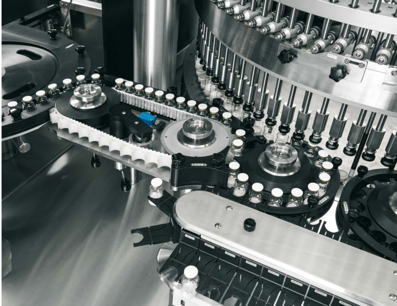
Hohe Geschwindigkeit und Präzision – eine Inspektionsmaschine von InnoScan untersucht in der Regel 10 bis 25 unterschiedliche Merkmale bei einer Geschwindigkeit von fast 650 Fläschchen pro Minute.
