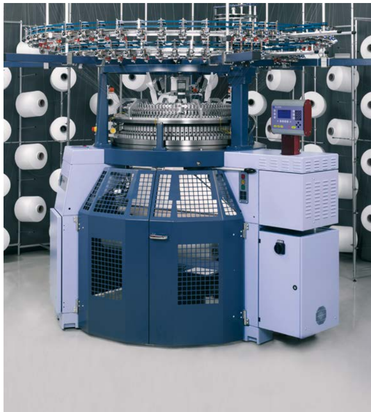
Großrundstrickmaschine Single-Jersey S296-2, bei der Terrot auf Automatisierungstechnik von B&R setzt.
