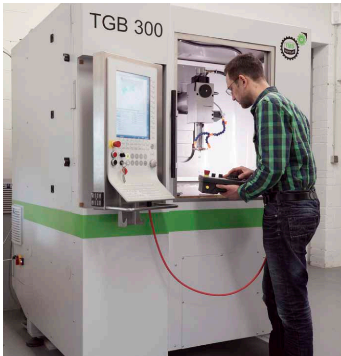
Das Glasbearbeitungszentrum TGB 300 nutzt integrierte Sicherheitstechnik von B&R sowie sicher begrenzte Geschwindigkeit und kann daher zum Einrichten mit offener Schutztür betrieben werden.
