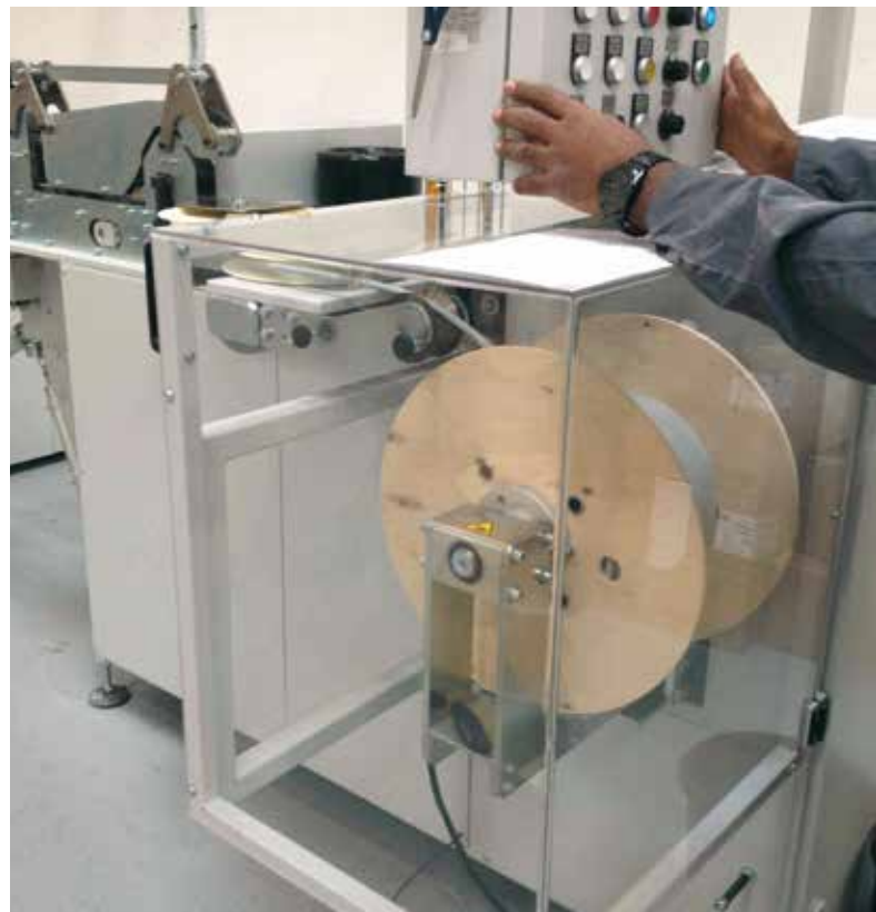
Die dreh- und schwenkbare Bedienkonsole erlaubt dem Bediener einen optimalen Blick auf die Wicklung des Kabels.
