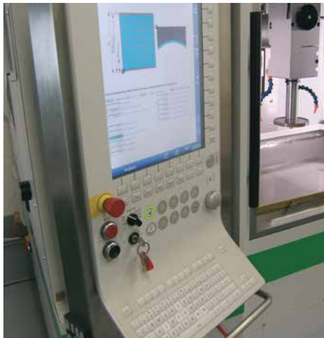
Das CNC-Panel von B&R vereint alle Elemente wie Touch-Display, Schlüssel-schalter, Tastatur und Not-Aus für die Bedienung einer CNC-Maschine in einem ergonomischen Gehäuse.
