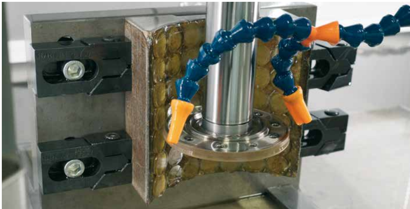
Das universell einsetzbare Glasbearbeitungszentrum TGB 300 von TMS nutzt durchgängig B&R-Automatisierungstechnik und eignet sich daher für viele Anwendungsfälle einschließlich der Herstellung von Zylinderlinsen
