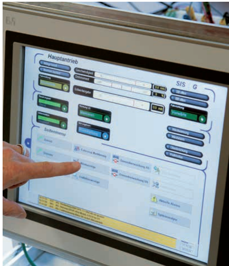
Bei der neuen Jakobshornbahn werden eine Speicherprogrammierbare Steuerung (SPS), ein Touchpanel für die Bedienung in den Stationen und in den Kabinen und Frequenzumrichter für kleinere Hilfsantriebe von B&R verwendet.
