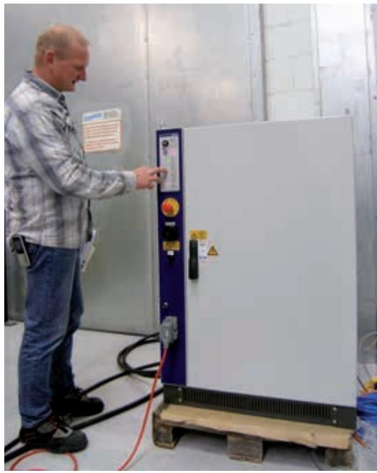
Der nach den Vorgaben von b+m gestaltete Schaltschrank benötigt weniger Platz und lässt sich aufgrund der B&R-Technik schneller aufbauen und verkabeln. Durch die erreichte Reduzierung der bewegten Teile und den Einsatz der Cold-Plate-Varianten konnte die Lebensdauer des Systems verlängert werden.
