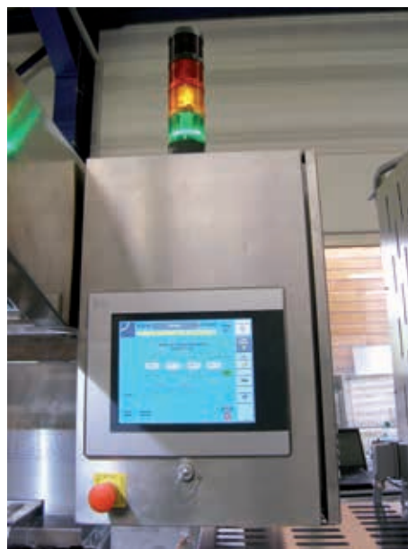
Die Steuerungs- und Visualisierungsanwendung hat Opelka komplett mit Automation Studio, der Engineering-Umgebung von B&R, erstellt. Durch die enge Integration sind die Programmierung, Diagnose und Wartung der Anlage besonders effizient.
