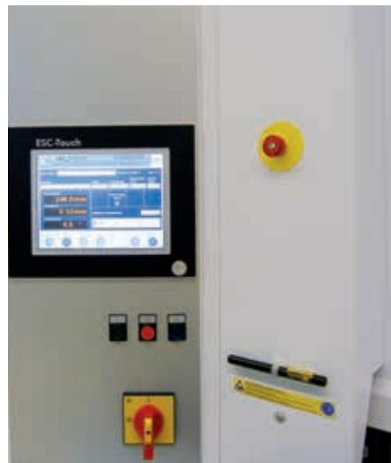
Die neue ECS-Touch-Steuerung von EHT basiert auf dem Power Panel 520 von B&R. Es steuert alle Abläufe der Maschine und dient gleichzeitig als Visualisierungsplattform und Bedienerschnittstelle.
