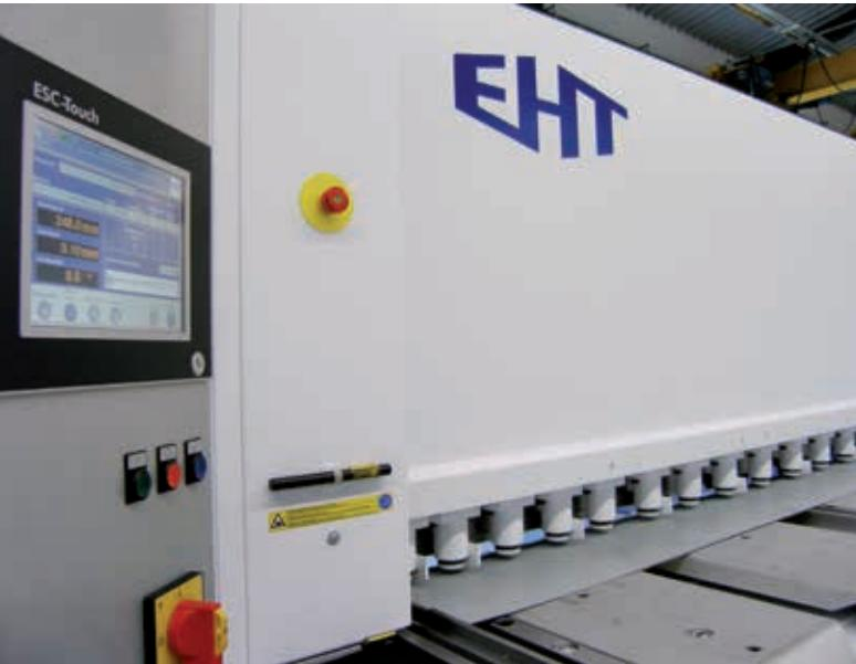
Die Positionierung des elektrischen Hinteranschlags übernimmt bei der MultiCut ein Wechselstrommotor, der von einem ACOPoSInverter angesteuert wird. Dabei wird eine Positionierungsgenauigkeit erreicht, wie sie sonst nur mit einem Servo möglich ist.
