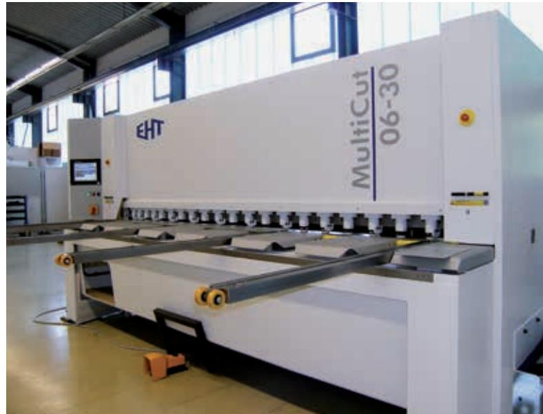
Die Tafelblechscheren der MultiCut-Serie mit neuer ECS-Touch-Steuerung sind für den Einsatz in Einzel- und Serienproduktion großer sowie kleiner Teile konzipiert. Sie erlauben aufgrund ausgeklügelter Mechanismen ein besonders wirtschaftliches und ergonomisches Arbeiten.
